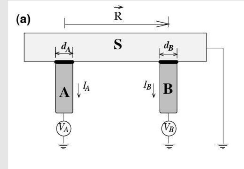
$$\begin{pmatrix} I_A \\ I_B \end{pmatrix} = \begin{pmatrix} G_{DA}^A + G_{CA} + G_{EC} & G_{CA} - G_{EC} \\ G_{CA} - G_{EC} & G_{DA}^B + G_{CA} + G_{EC} \end{pmatrix} \begin{pmatrix} V_A \\ V_B \end{pmatrix}$$
